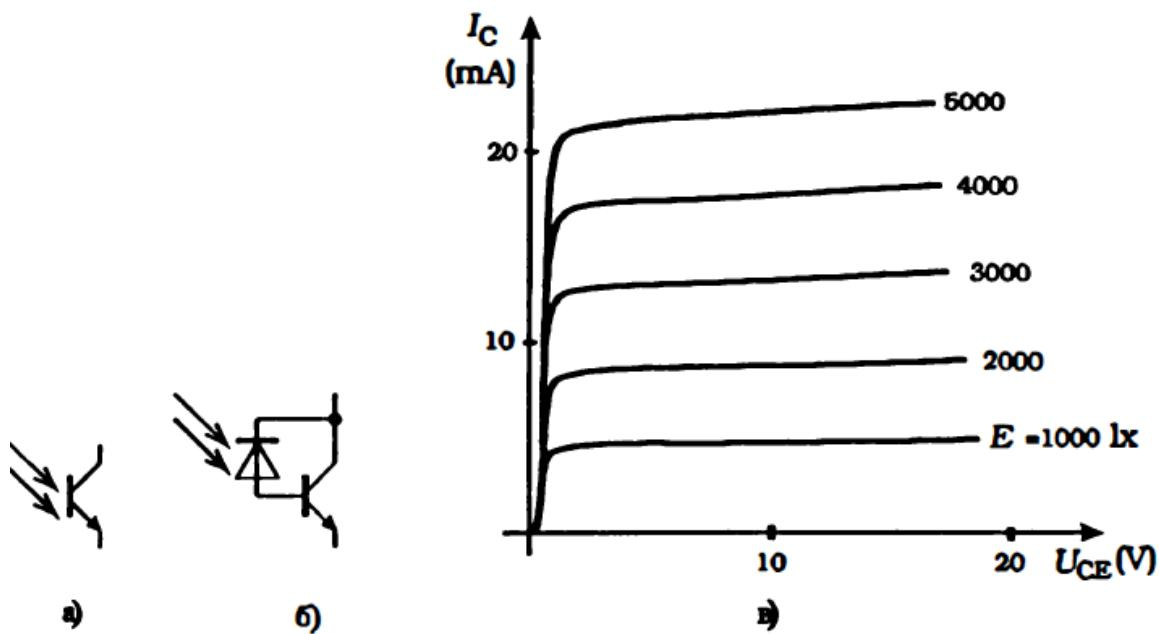
Spoj baza-kolektor se ponaša kao fotodioda pa fototranzistor možemo predstaviti kao na slici pod B. Udarom svetlosnih zraka u PN spoj baza-kolektor, raste inverzna struja koja se dodatno povećava koeficijentom strujnog pojačanja pa se dobija znatno veća struja koju takođe možemo dodatno povećati ako povećamo osvetljenost. Karakteristike fototranzistora su prikazane na slici pod B.
